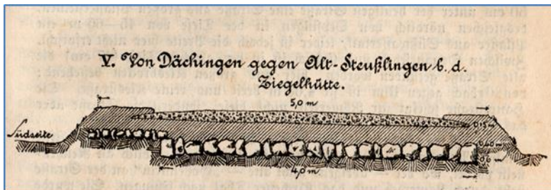
Schnitt durch die römische Alb-Quer-Straße bei Dächingen aus der Oberamtsbeschreibung 1893, S. 311
