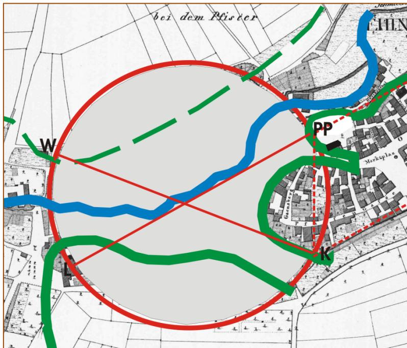
Wir erhalten einen Schnittpunkt auf der Planunterlage um den wir den **Umkreis** um die spätere Untere Stadt zeichnen. Mit 700 Fuß Radius bzw. 1400Fuss Durchmesser. Der Umkreis um die Obere Stadt hatte 500 Fuß Radius. Tatsächlich wird aus diesem einfachen Vergleich bereits deutlich, dass die Untere Stadt großzügiger angelegt war, als die Obere Stadt.
